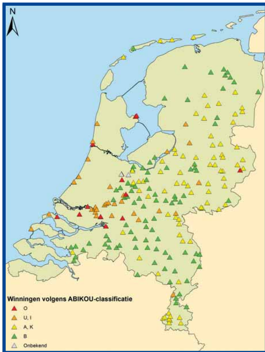
Afb. 1: Kwetsbaarheid van winningen voor verontreinigingen op basis van de ABIKOU-indeling: O = oppervlaktewaterwinning; U = oeverinfiltratie; I = kunstmatige infiltratie; A = freatisch grondwater; K = winning uit kalksteen; B = (semi-)spanningsgrondwater onder slecht doorlatende lagen.
